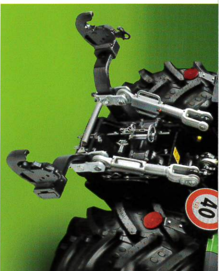
➡ Elektronisch gesteuerter Heckkraftheber mit einer maximalen Hubkraft von 2600 kg.
