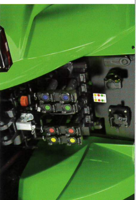
➡ Vier elektrohydraulisch betriebene doppelt wirkende Steuerventile für eine einfache und traktoreigene Bedienung von Anbaugeräten.
