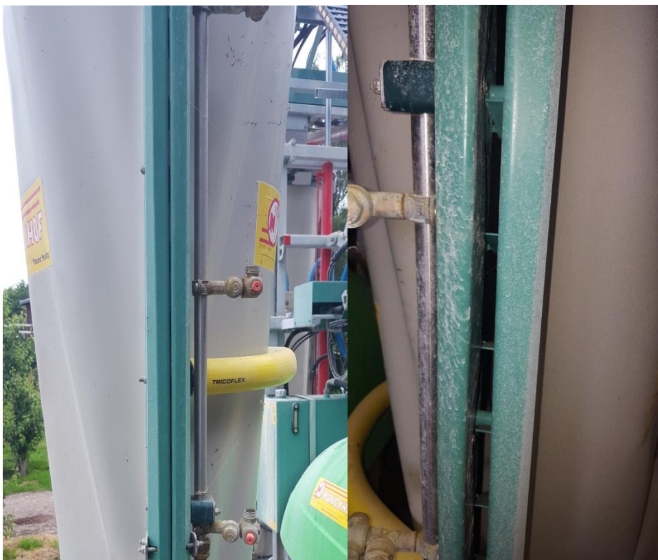
Figuur 3 Dichte luchtuitstroomopening (links) en open luchtuitstroomopening (rechts) door de afsluitbare kleppen aan weerszijden van de buitenste luchtzakken.
