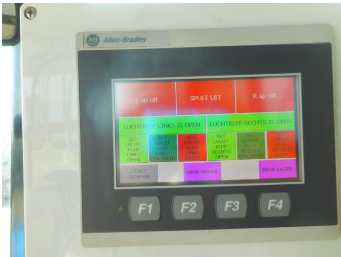
Figuur 2 Scherm van spuitcomputer met daarop per spuitrichting (links/rechts) een drukknop voor de bediening van de luchtklepinstelling OPEN (lichtgroen), 80% dicht (donker groen) en DICHT (rood).
