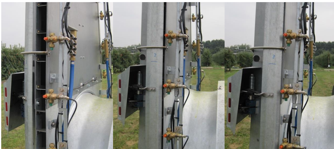
Figuur 3 Klepstanden van het Air Closing System bij de luchtklepinstelling OPEN (links), 80% dicht (midden) en DICHT (rechts).
