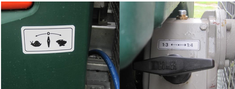
Figuur 5 Stand van de overbrengingsverhouding van de ventilator op de Lochmann dwarsstroomspuit (links: indicatie op de tank en rechts: stand van de handgreep).
