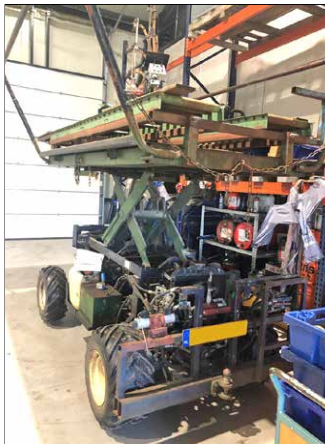
Zelfgebouwde machine zonder CE-markering. Foto: Stigas
